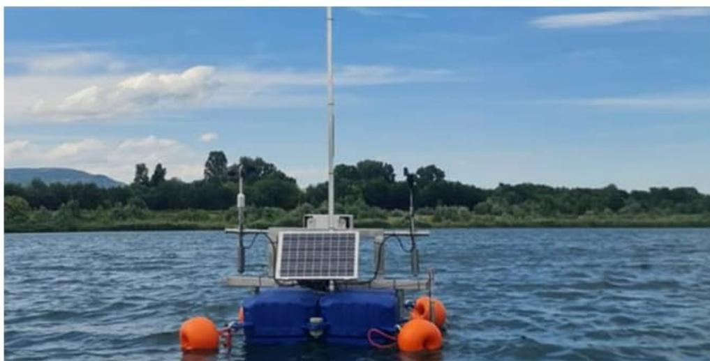
Une station autonome (batterie + panneaux solaires) qui permettra d'étudier l'impact climatique. DDM.
